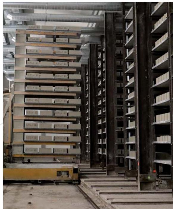
De la fabrication à la fin de vie du produit, l'empreinte carbone des blocs Fabemi est maîtrisée grâce à une production locale (impact du transport très faible) et à un procédé de fabrication frugal sans cuisson. Les blocs sont produits avec des agrégats provenant de carrières situées à proximité des usines Fabemi, auto-étuvés naturellement, et utilisés sur des chantiers proches des unités de production, ce qui limite le transport et donc l'impact environnemental.
